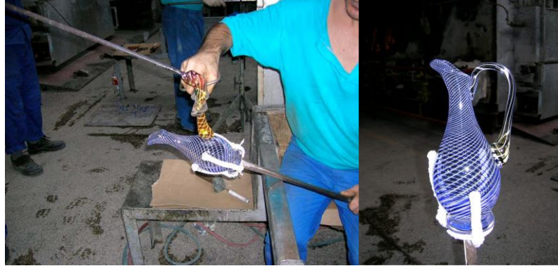
Şekil 5.72-73: Denizli Cam' Çeşm-i bülbül üretimi (Onur 2007)
